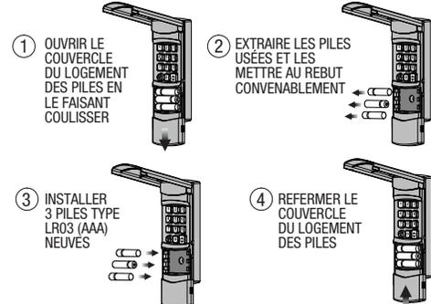
Procéder comme indiqué sur le schéma, en veillant à tenir les piles à l'écart des enfants. Le fonctionnement nécessite 3 piles alcalines type LR03 (AAA). Mettre les batteries usagées au rebut de manière correcte. De nombreux magasins d'électronique et supermarchés disposent de réceptacles destinés aux piles à recycler. Les piles alcalines peuvent être mises dans les ordures ménagères en toute sécurité. Ne jamais mettre des piles dans le feu, où elles risquent d'exploser.
